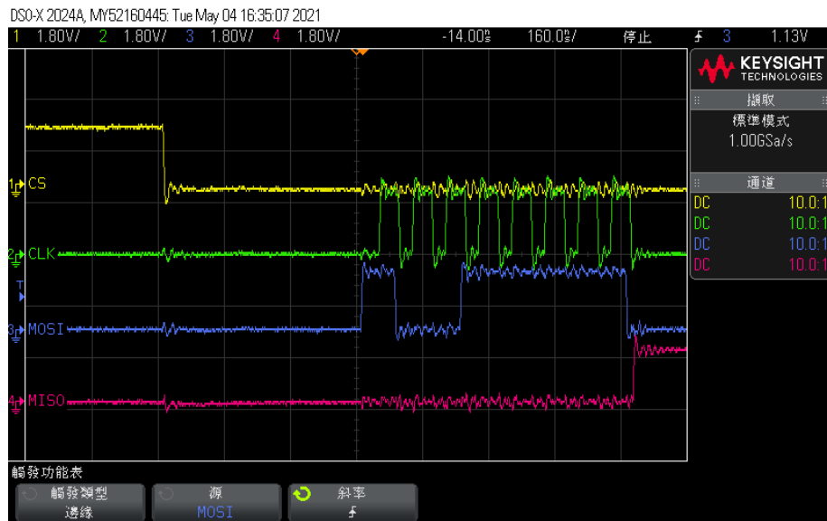
圖: 示波器量測 MOSI 輸出的 Read ID Command 為 9F，波形正確。
