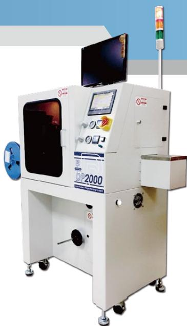
DP2000 是特別針對管裝或捲帶進料並以捲帶方式出料而設計的專用自動化燒錄系統。系統配置 4 支 IC 取放吸嘴分別同時進行 IC 入料、定位、燒錄及出料取放動作並另外搭配移動式燒錄模組。藉由取放吸嘴與燒錄模塊交叉同動達到 3,000UPH 高產能；此項創新設計概念已經獲得專利認證。
